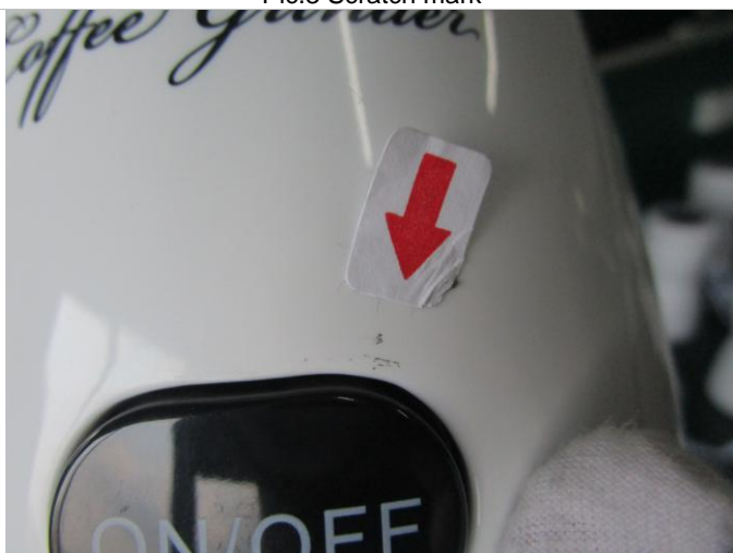
Pic.5 Dirt mark
