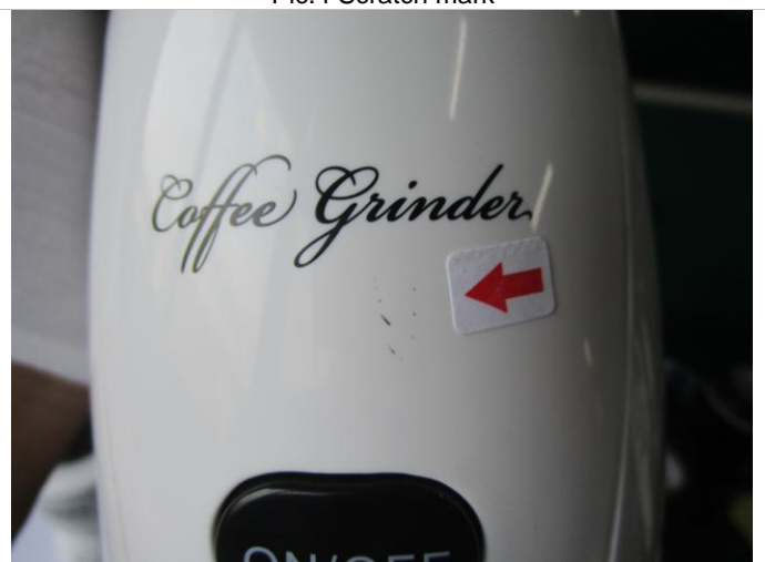
Pic.6 Dirt mark
